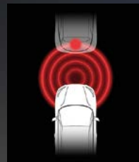
Varování před čelním nárazem (FCW)
